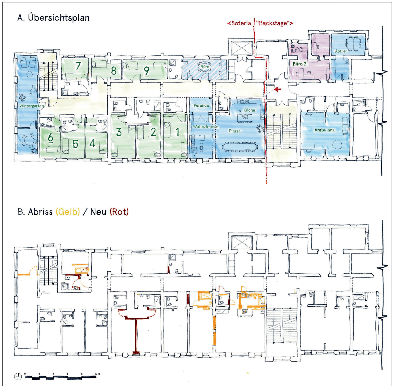
Abb. 2 Grundriss der Soteria Berlin. (A) Die Patientenzimmer 1–9 (grün) sind umgeben von Gemeinschaftsräumen (blau). Außer dem Büro, das jederzeit für Patienten zugänglich ist, sind die Büros der Mitarbeiter ausgelagert („Backstage“). (B) Der Grundriss wurde nur an wenigen Stellen durch Abriss (gelb) und Neubau (rot) geändert. Der Fokus lag auf der Schaffung eines zentralen Wohn- / Essbereiches sowie des Wintergartens.
